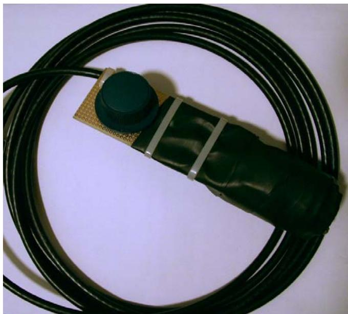
Fig. 6 – Antenna sintonizzabile per ELF
